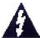
Молния со стрелкой, ограниченная равносторонним треугольником, предназначена для предупреждения пользователя о наличии опасного напряжения внутри корпуса изделия, достаточно большого, чтобы вызвать поражение человека.
