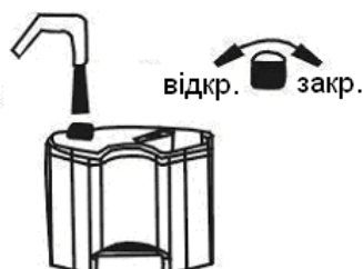
5. Зніміть кришку отвору для наповнення води і налейте води в резервуар
